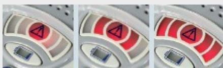
Wizualny wskaźnik proporcjonalny do siły sygnału metalu (niski, średni, wysoki)
